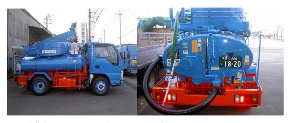
↑し尿収集車です。バキューム車を用いて吸引、清掃します。
