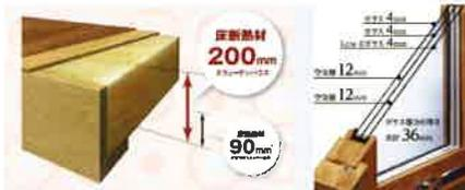
次世代省エネ基準を大幅に超える200mmの床断熱材、窓は3層ガラスの木製サッシを採用。魔法瓶のような構造で高い保温性を実現し、冷暖房費を軽減します。また壁厚は約30cm、高い遮音性で隣室への生活音にも配慮。
