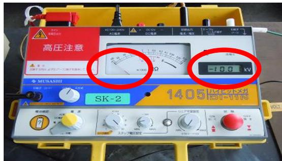
1万ボルトに昇圧。計測器の針は常に∞を指している。
