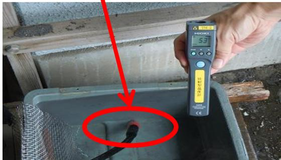
プラグ先端部にLLFAテープを防水加工にて施工。その後、50℃以上の温水に2時間水没させる。
